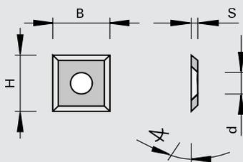
твердый сплав [HW]
