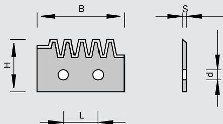
твердый сплав [HW]
