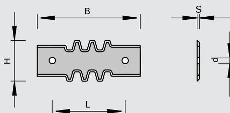
твердый сплав [HW]
