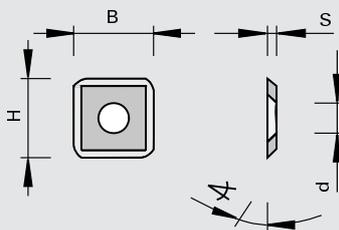
твердый сплав [HW]
