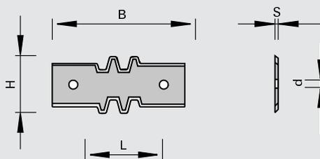
твердый сплав [HW]
